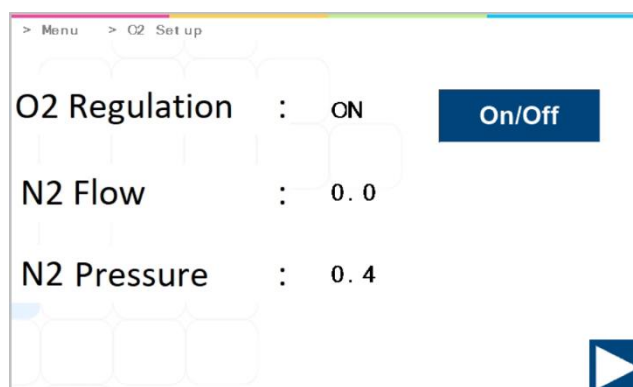
Figur 13.26 Undermenuen Opsætning af O 2 -mængden på MIRI® TL6 og MIRI® TL12 multiroom IVF-inkubatoren
