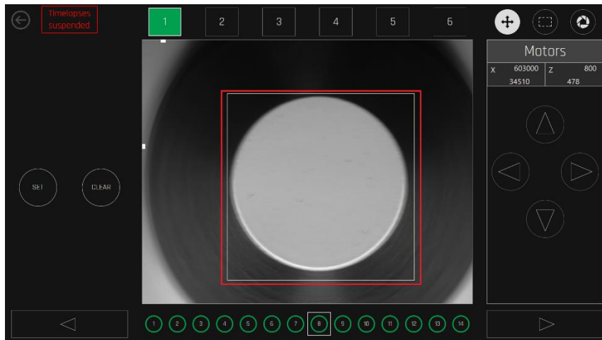
Figur 20.39 En brønd, der er justeret rigtigt
