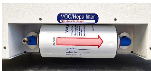
Figur 12.3 Korrekt monteret VOC/HEPA-filteret
